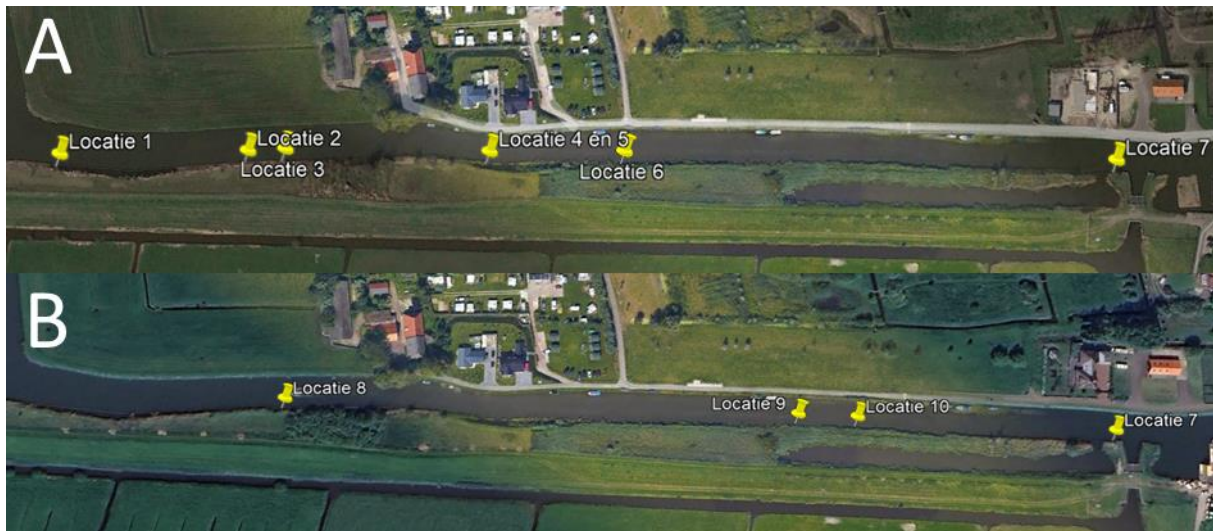
Figuur 2.1: Onderzoeklocaties langs de Zweth gedurende (A) 2020 en 2021 en (B) 2024. Locatie 1: volledig dichte combiwand; 2: combiwand met kleine openingen; 3: een palenrij; 4: wilgentenen; 5: een damwand met wilgentenen inclusief kleine openingen; 6: een dichte damwand met wilgentenen; 7: geen bescherming; 8: palenrij met gebonden wiepen; 9: palenrij met houten planken en 10: palenrij met jute.
