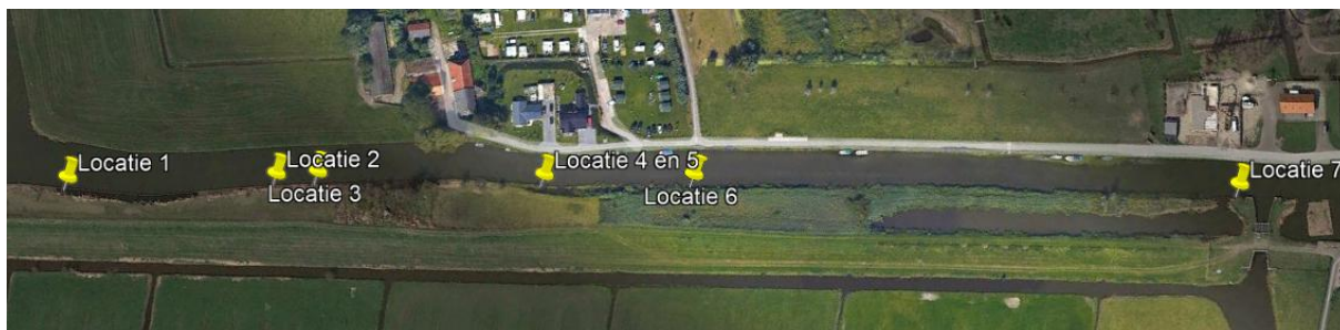
Figuur 2.1: Onderzoeklocaties langs de Zweth (Locatie 1: volledig dichte combiwand; 2: combiwand met kleine openingen; 3: een palenrij; 4: wilgentenen; 5: een damwand met wilgentenen inclusief kleine openingen; 6: een dichte damwand met wilgentenen, en 7: geen bescherming).
