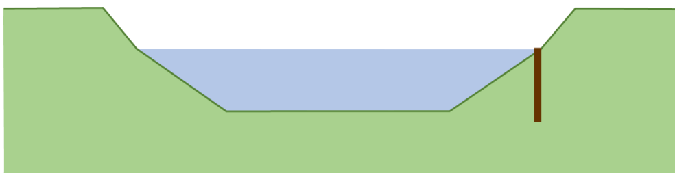
Figuur 3. Voorbeeld van onderwaterbeschoeiing voor de stabiliteit van de oever.
