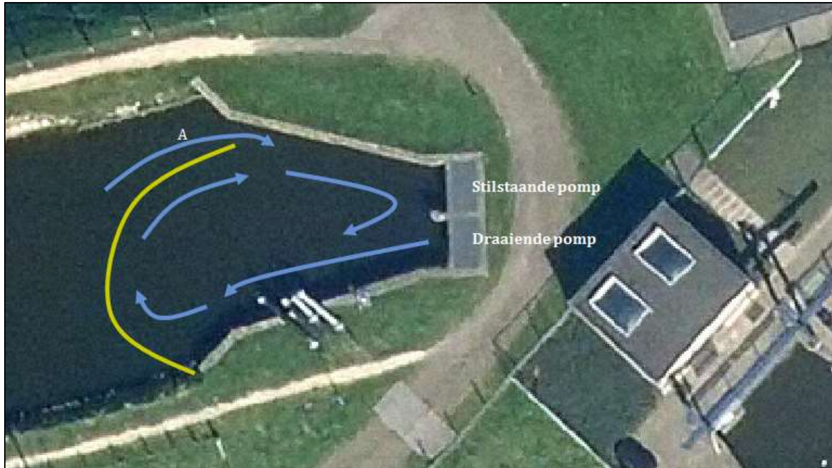
Figuur 16: situatie van de ontstane kolk bij inzet van 1 pomp; het krooscherm is de gele lijn, in blauwe pijlen de ontstane stroming voor wat betreft het wateroppervlak, en bij A werd door de stroming kroos langs het scherm geforceerd
