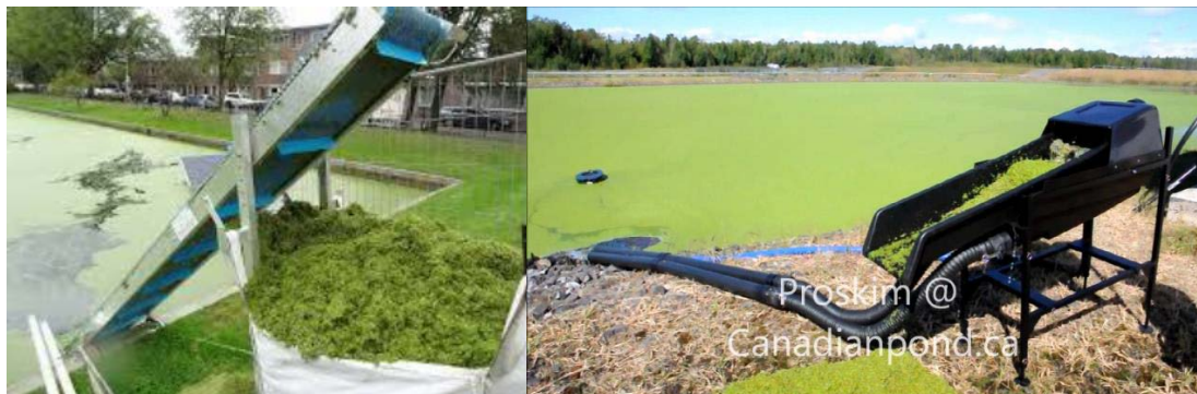
Figuur 6.6 Transportband (links) en kroos-skimmer (rechts)
