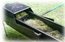
Figuur 52: Kroosfiltersysteem op de kant. Bron: (ProSkim)
