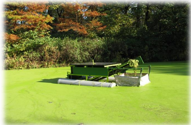
Figuur 55: Krooswiel op zonne-energie. Bron: (Hoogheemraadschap van Delfland)
