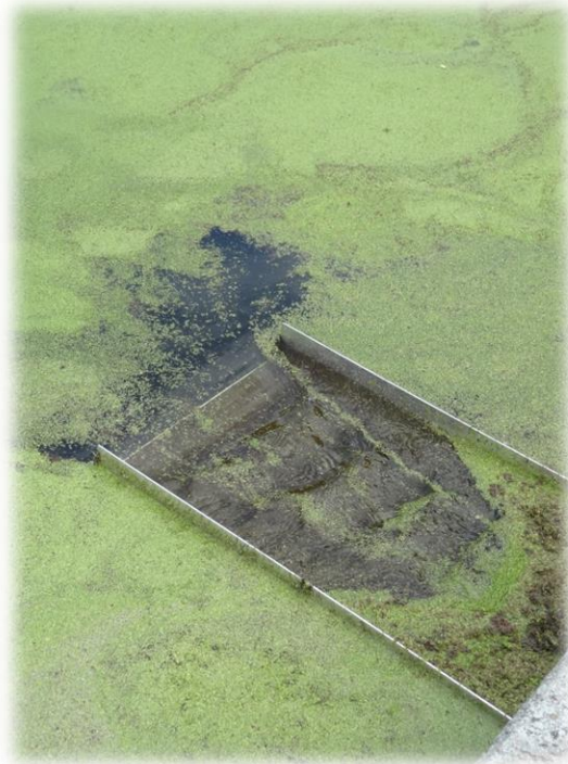
Figuur 11: De kroosslurper in werking. Bron: (Bom Aqua)
