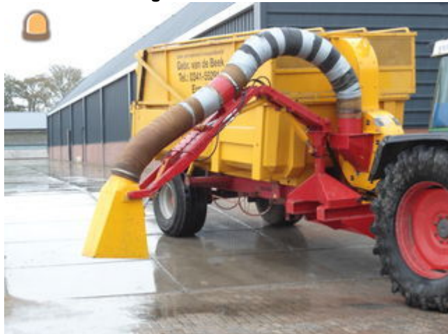
Figuur 3.2 Trekker met zuigermond en opvangbak. Foto: www.entreeding.com
