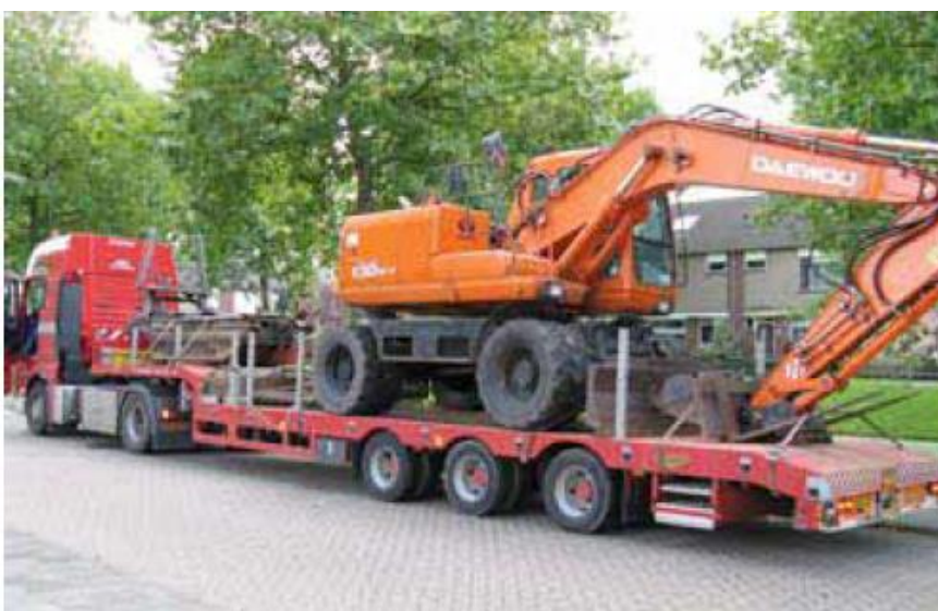
Figuur 5.11 Aanvoer kraan met zeefbak
