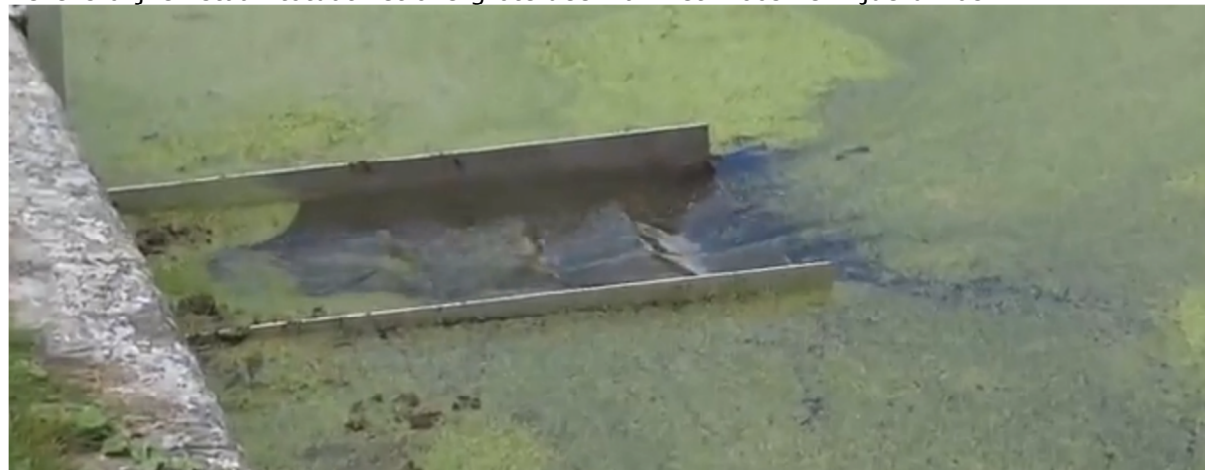
Figuur 5: Kroosslurper aan het Chrysantplein van opzij gezien
