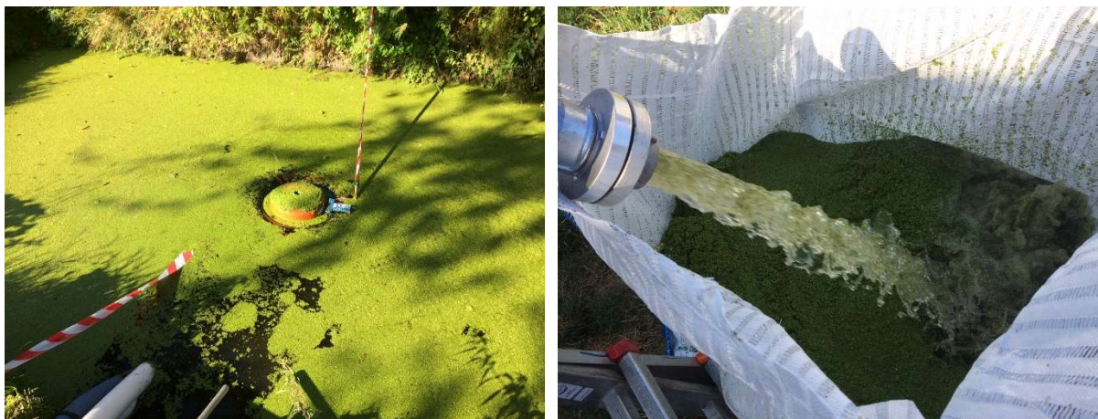
Figuur 7 De kroospomp zuigt het kroos af en via een big bag wordt het kroos uit het water gezeefd.
