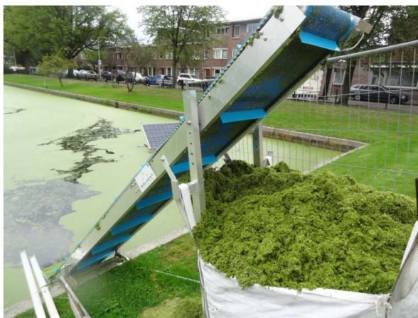
Figuur 39: Onderdeel van de test met een kroosslurper bij Chrysantplein, waarbij de lopende band is ingezet om het kroos naar een stortzak af te voeren, augustus 2013.
