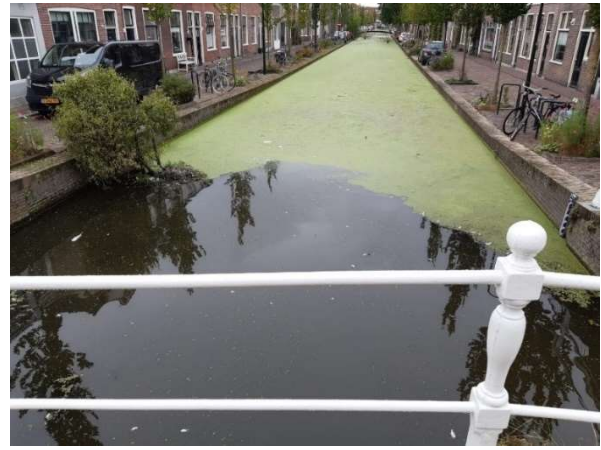
Figuur 51: Foto's van de grachten van het Rietveld. Links blijft, op het verre uiteinde van de gracht het kroos hangen achter de drijfbladvegetatie waarbij het allerlaatste deel wel vrij kwam van kroos, en rechts kon de pomp bij windstilte het kroos wel opduwen (pomp onder de brug vanwaar de foto is genomen, net uit beeld) maar het kroos kon niet weg. Deze locaties zijn gemarkeerd in figuur 49.
