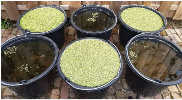
Figuur 22: Opzet van het experiment in emmers om (onder gecontroleerde omstandigheden) de relatie tussen kroosbedekking en de zuurstofconcentratie te onderzoeken [32].
