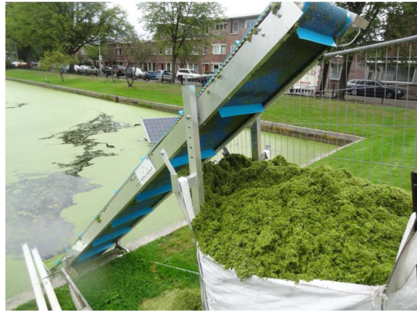
Figuur 65: Onderdeel van de test met een kroosslurper bij Chrysantplein, waarbij de lopende band is ingezet om het kroos naar een stortzak af te voeren, augustus 2013.
