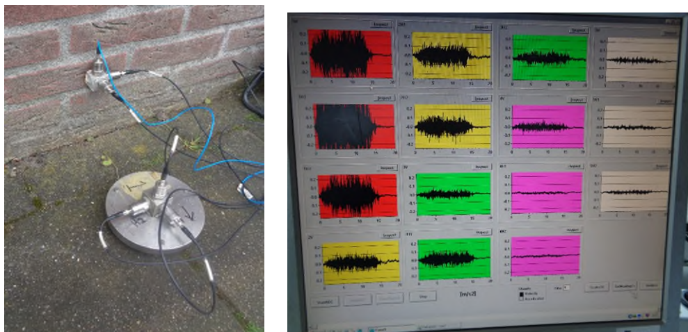
Figuur B2: Type B meting, meetpunten op maaiveld en aan de gevel, beeldscherm meetresultaat 5 meetpunten (iedere kleur = 1 meetpunt)
