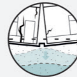
Verzakking door grondwaterontrekking
