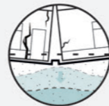
Verzakking door grondwaterontrekking
